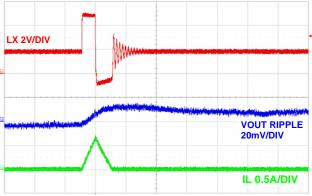
FIGURE 16. STEADY STATE OPERATION AT NO LOAD (PFM), (1µs/DIV)
