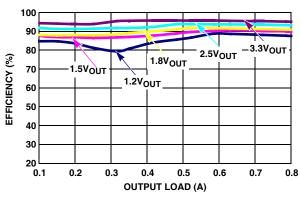
FIGURE 6. EFFICIENCY vs LOAD (1MHz 5V<sub>IN</sub> PFM)
