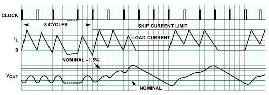
FIGURE 33. SKIP MODE OPERATION WAVEFORMS
